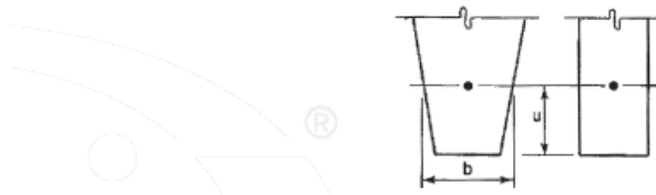
شکل ۴-۲-۳-پ- دماها در واحدهای بتنی معمولی مستطیلی و مخروطی برای سه ساعت در معرض آتش بودن
